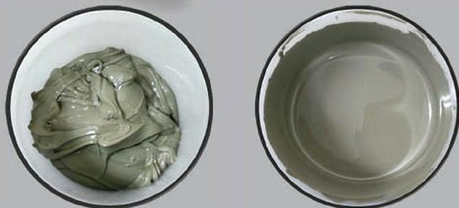
五萬CPS黏稠度的銀漿，攪拌5~10分鐘即可均勻及完全去除氣泡，並可使溫度控制在溫升5度內
