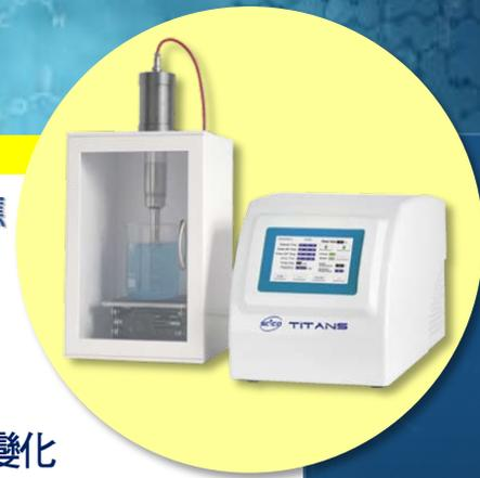
◆ 應用領域: 奈米化分散 / 細胞破碎 / 中草藥萃取 / 微波+超音波合成反應
